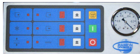
PANEL DE CONTROL VACIO Y GAS
